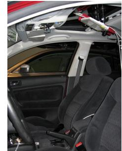
(d) Camera and illuminator set-up.
